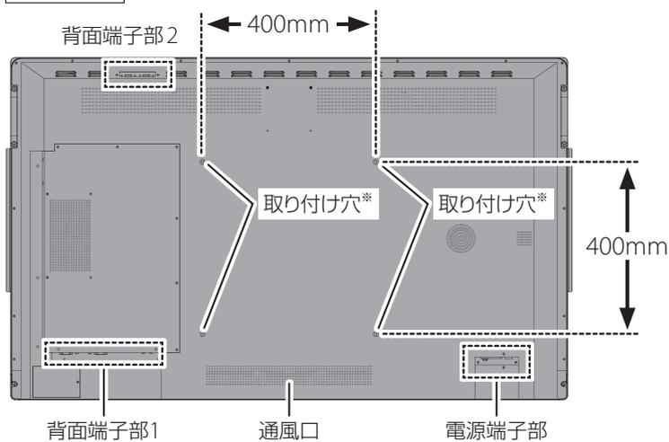
※ 取り付け穴用ネジのサイズ：M8×25
