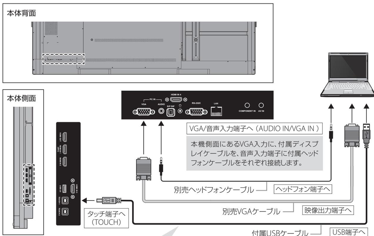
本機側から接続したPCのタッチ操作をするときは、付属のUSBケーブルで、本機のタッチ端子 (TOUCH)とPC側のUSB端子を接続します。
