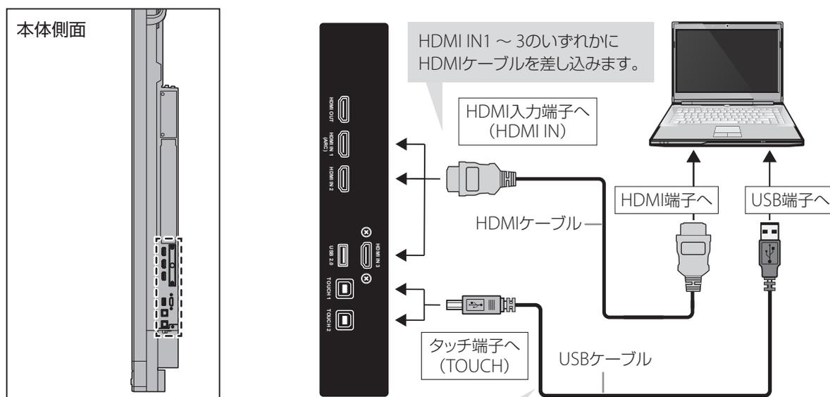
本機側から接続したPCのタッチ操作をするときは、付属のUSBケーブルで、本機のタッチ端子 (TOUCH)とPC側のUSB端子を接続します。
